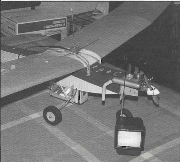
Foto 3 - Una visione d'insieme dell'aeromodello Butterfly equipaggiato con la ATV Airborne. Da notare l'antenna montata sopra l'ala, in seguito spostata verso l'estremità posteriore della fusoliera, dove ha dato migliori risultati.
