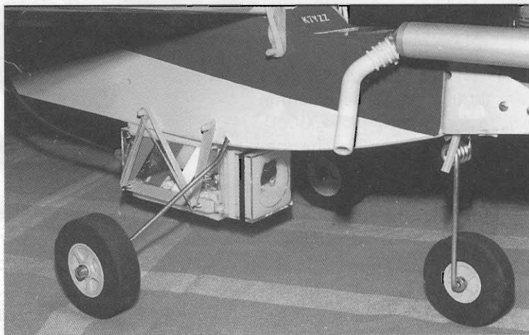
Foto 1 - Installazione della scatola sotto la fusoliera di un aeromodello.
