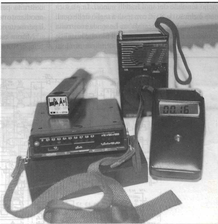
Foto 1 - Foto di gruppo: i due contatori, il modello veicolare ha la cinghia per l'uso in portatile. A destra il contatore è collocato nella propria custodia. Sul fondo una radiolina russa, la cui copertura si estende dalle onde medie alle corte, è assente l'FM.
